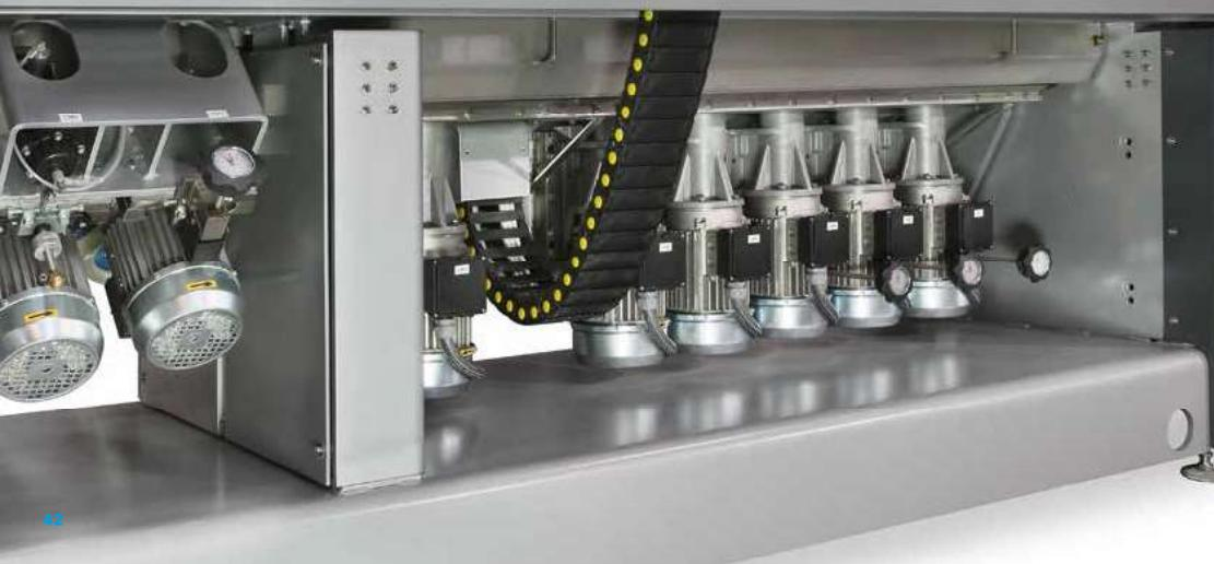
Diese Maschine ist für hervorragende Qualitätsbearbeitungen geeignet (wie sie von der Innenausstattungsindustrie gefordert werden). Es können bis zu 4 Kanten bei einem einzigen Durchgang bearbeitet werden (3 davon werden mit Ceriumflüssigkeit behandelt). Dort eingesetzt, wo hohe Feinbearbeitungsqualität und Glanz, sowie große Präzision erforderlich werden, wie z.B. bei Tischplatten und Aquarien.
