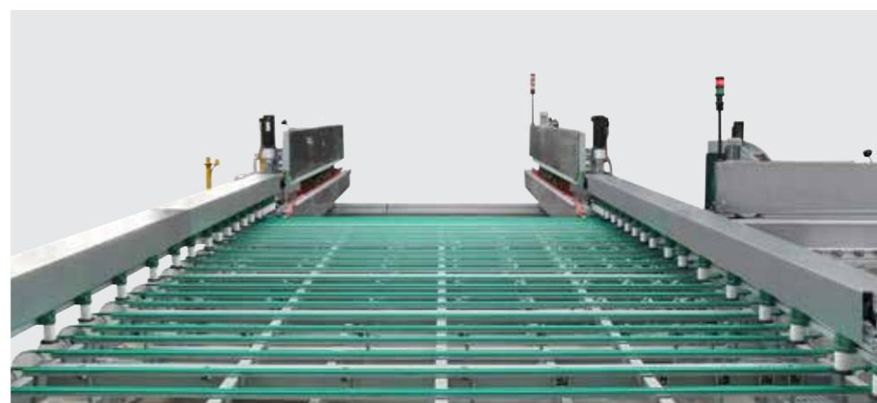
*Im Transfer wird die Glasscheibe von der oberen Ebene der 1. Titan-Maschine über ein Druckluftsystem mit Rädern auf die Transportriemen des Transfers abgelegt. Dadurch wird jede Art von Beschädigung auf der Glasscheibe verhindert.*
