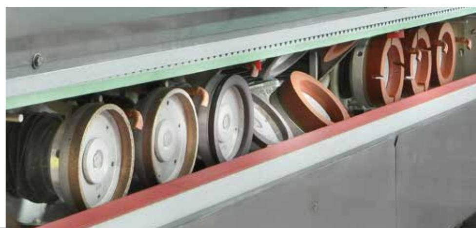
*Durch die automatische Einstellung der Diamantspindeln für die Flachkante verringert sich der Verschleiß der Diamantscheiben. Die Einstellung wird von dem Maschinenbediener gemäß der eingegebenen Parameter und einer automatischen und regelmäßigen Kalibrierung ausgeführt. Über den Wasserkreislauf werden die Schleifscheiben mit jeweils 2 Kupferdüsen gekühlt. Dieses Material ist resistent gegen Schmutzwasser und garantiert so Leistungsfähigkeit und lange Lebensdauer.*
